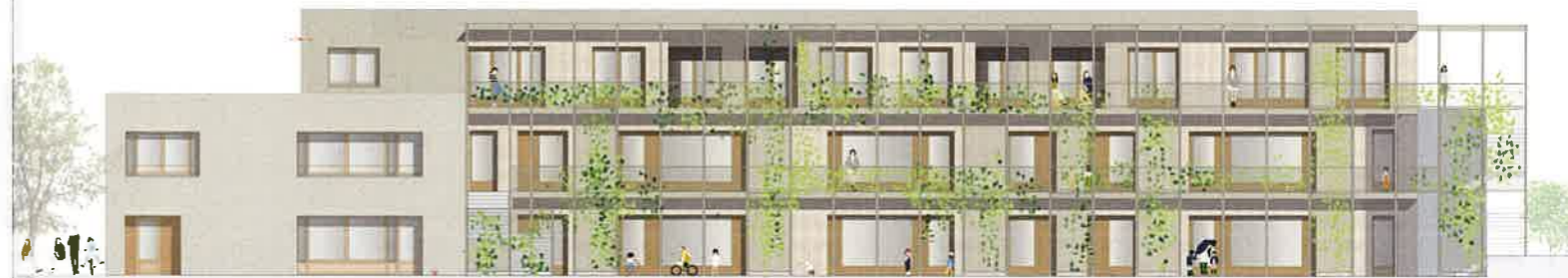
Die Kita Sonnenland ist ein Low-Tech-Gebäude mit Nachtauskühlung. Bestandteil des Energiekonzepts sind die Bauteile aus Beton, die als Speichermassen dienen, sowie die Fassadenbegrünung der Gartenseite.
